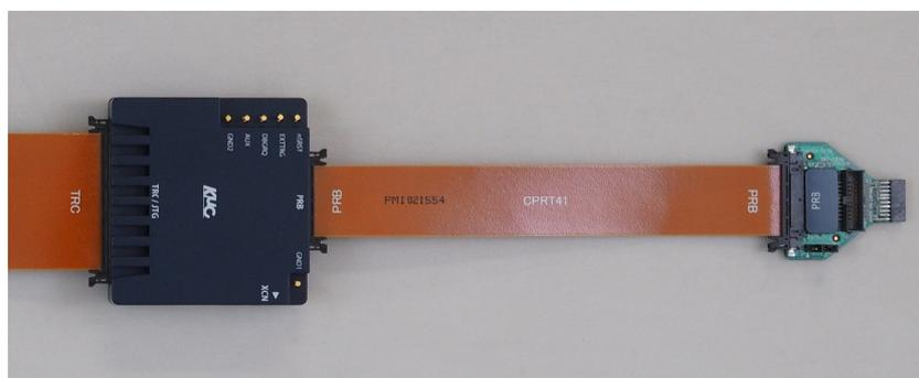
図3 Cortex20ピンプローブ(オプション)使用時
