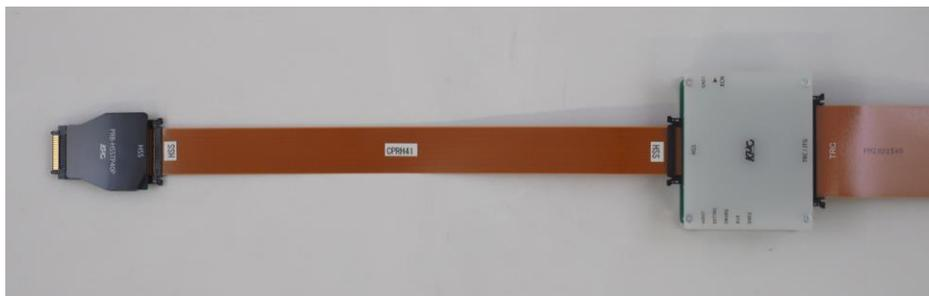
図2 HSSTP40ピンプローブ使用時
